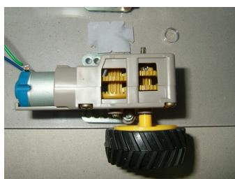
ロボットで使用するギヤボックス
