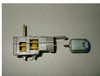
このギヤボックスの組み立ては、差し込むだけでできあがるように工夫されている。
