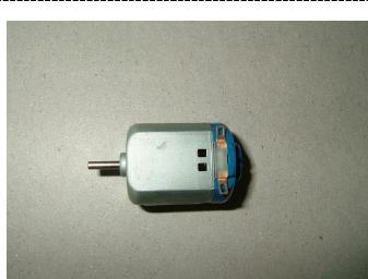
モーターの外観。ギヤボックスに付属している。
