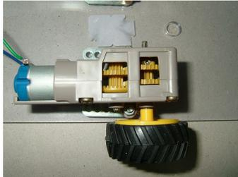
ロボットで使用するギヤボックス
