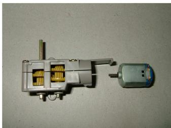
このギヤボックスの組み立ては、差し込むだけでできあがるように工夫されている。
